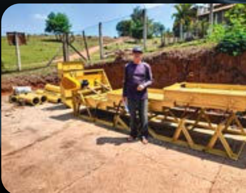
Cooperado Edivar de Oliveira Transportador, Peneirão, Elevador Metálico, Registro e Tubo Metálico
