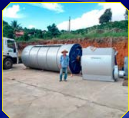
Cooperado Pedro Moreira Batista - Secador, forno, ventilador e alimentador de palha
